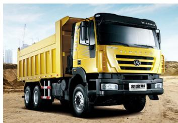
机方面，新金刚可装配柯索9（Cursor9）、上柴E系列和潍柴WP10三款发动机，在动力性和节油性方面都有出色的表现，充分满足用户差异化的需求；在驾驶室方面，新金刚采用高强度钢板、双面镀锌、高精度焊接，通过严格的欧洲碰撞标准验证（ECE R29），同时采用斜拉式减振装置，有效降低车辆
